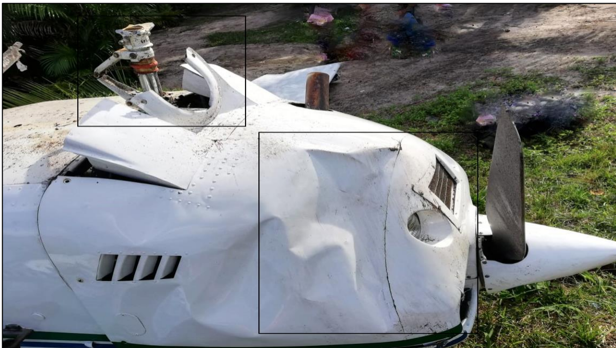
Fotografía No. 2: Daños en la planta motriz y en el tren de nariz.
