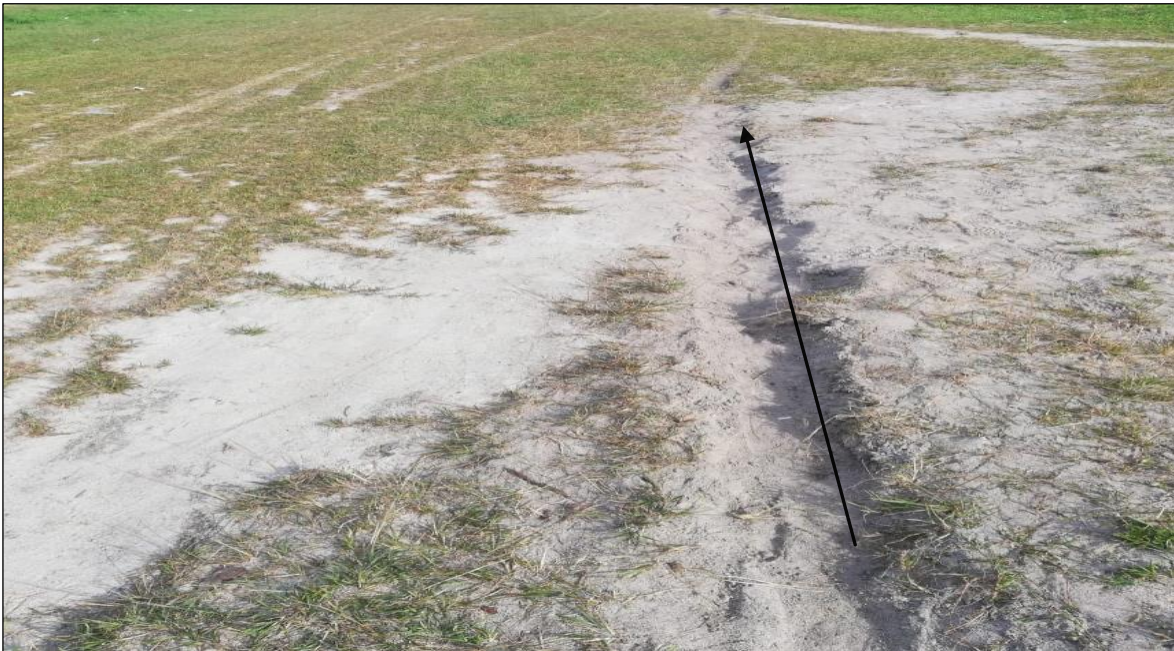
Fotografía No. 7: Marcas en el terreno por roce del muñón del tren principal derecho.
