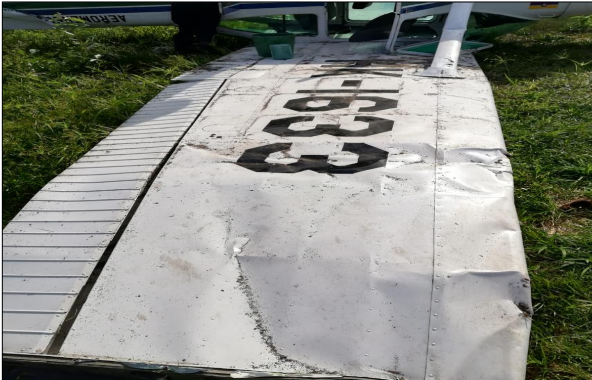
Fotografía No. 4: Daños en los planos
