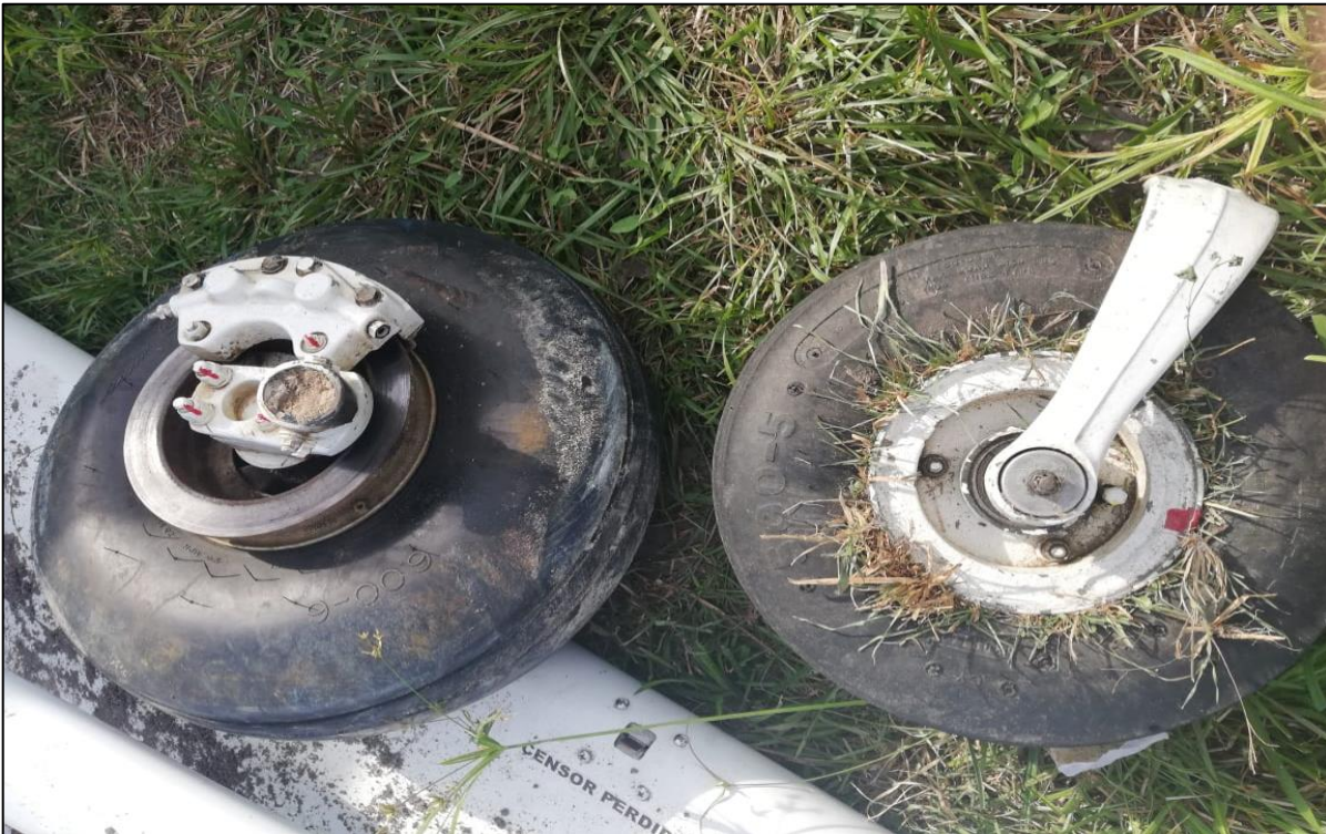
Fotografía No. 5: trenes de aterrizaje principal derecho y de nariz desprendidos.
